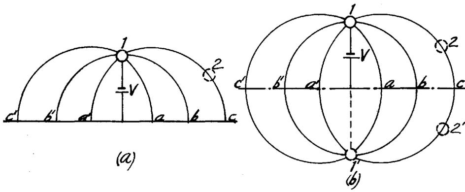
FIG. 2—FIELD OF A SINGLE WIRE TO EARTH
